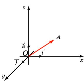
Теорема. Вектор  $\vec{a}$  имеет координаты  $(x, y, z)$  тогда и только тогда, когда он представим в виде  $\vec{a} = x\vec{i} + y\vec{j} + z\vec{k}$ .
