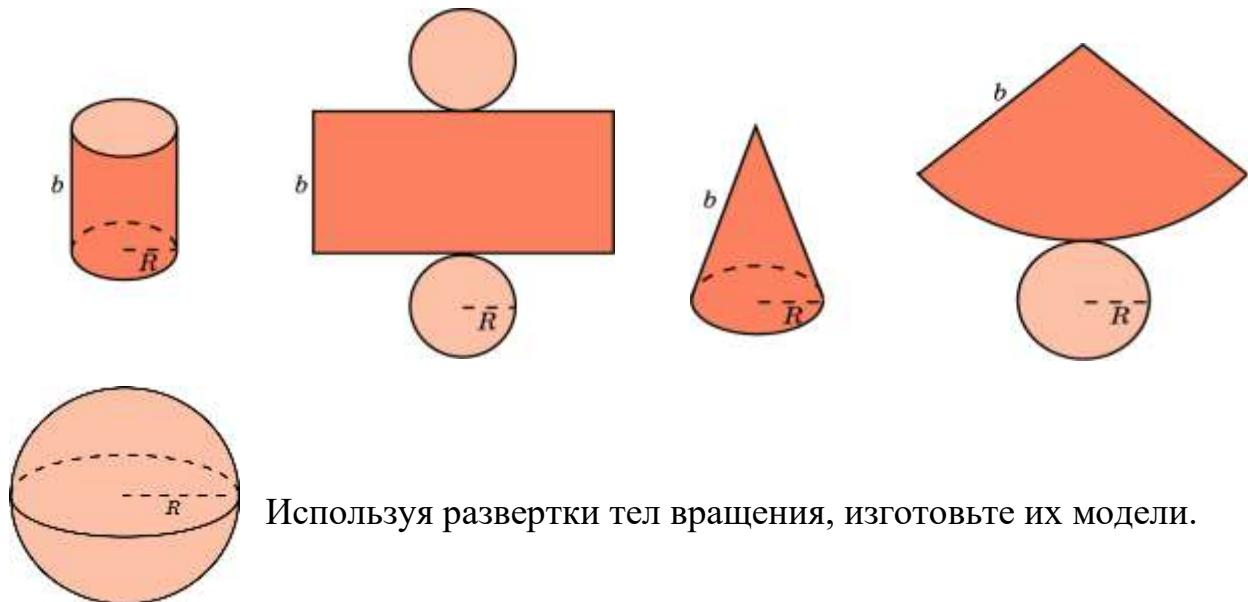
Используя развертки тел вращения, изготовьте их модели.
