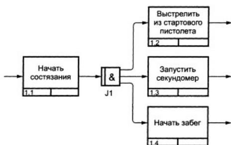
Заметим, что синхронное разворачивающее соединение не обязательно должно иметь парное себе сворачивающее соединение. Действительно, начинающиеся одновременно действия вовсе не обязаны оканчиваться одновременно, как это видно из примера с состязаниями. Также возможны ситуации синхронного окончания асинхронно начавшихся действий.
