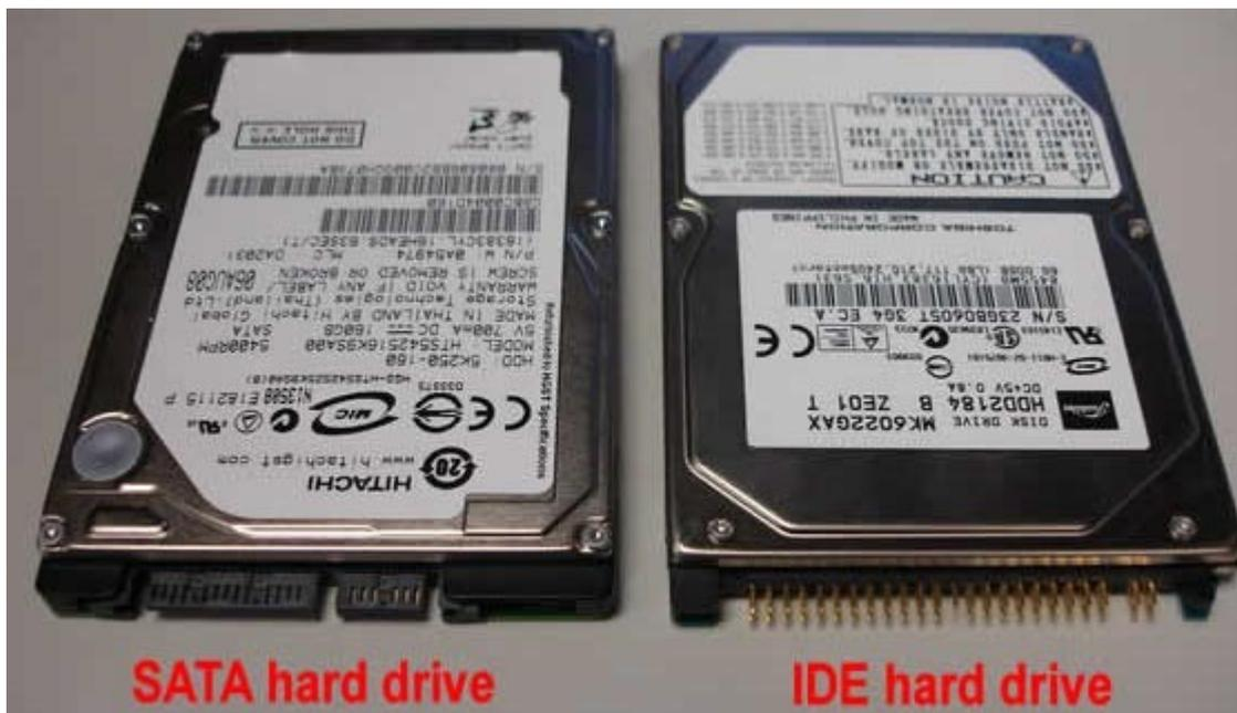
SATA (Serial ATA) – последовательный интерфейс обмена данными с накопителями информации. Для подключения используется 8-pin разъем. SATA является развитием параллельного интерфейса ATA (IDE), который после появления SATA был переименован в PATA (Parallel ATA). Стандарт SATA (SATA150) обеспечивал пропускную способность равную 150 МБ/с (1,2 Гбит/с).
