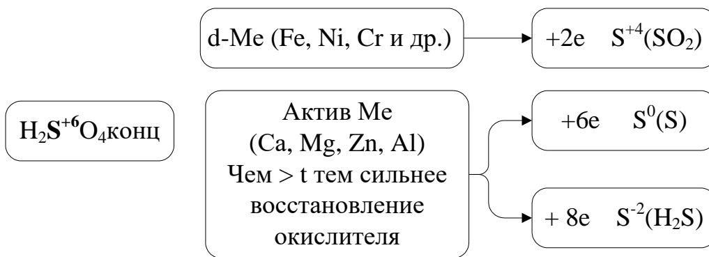
Рис. 12. Окислительная активность концентрированного раствора \text{H}_2\text{SO}_4
