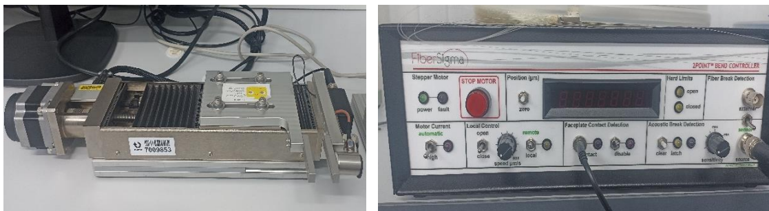
Рисунок 3.4 – Фотографии установки FiberSigma для исследования предела прочности волокна методом двухточечного изгиба
