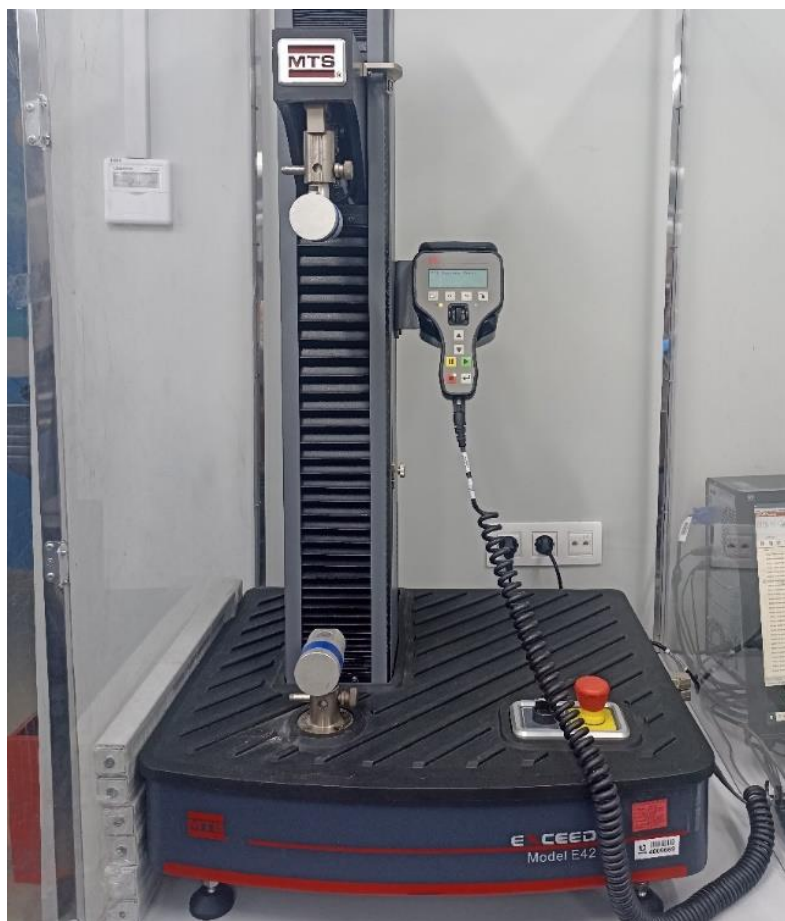
Рисунок 3.7 – Фотография разрывной машины MTS Exceed E.42 для исследования предела прочности волокна методом осевого растяжения
