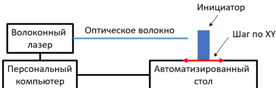
Рисунок 1.11 – Экспериментальная установка для исследования минимальной мощности для оптического пробоя
