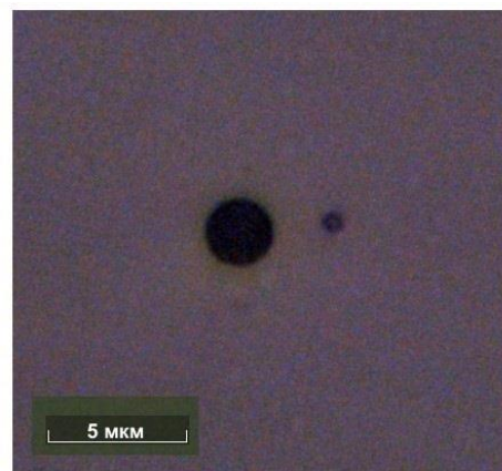
Рисунок 5 – Фотография торцевого скола с основной и дополнительной микрополостями
