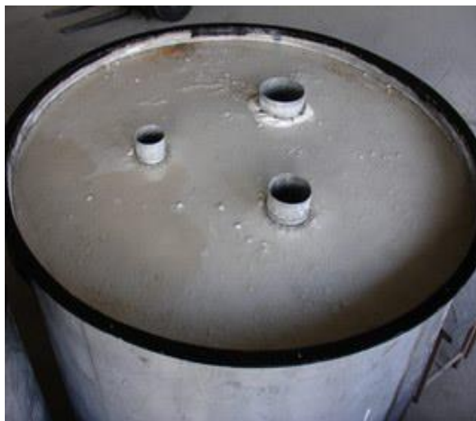
Рисунок 1.5 - Эталон кальцитовых пород (двухфракционный, диаметр 2 м, диаметр скважин - 124, 156 и 216 мм)
