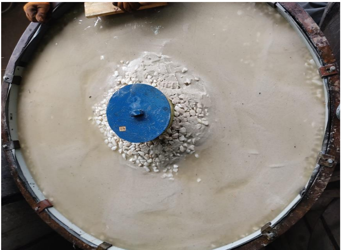
Рисунок 2.3 - Модель песчаного пласта двухфракционного состава (вид сверху)
