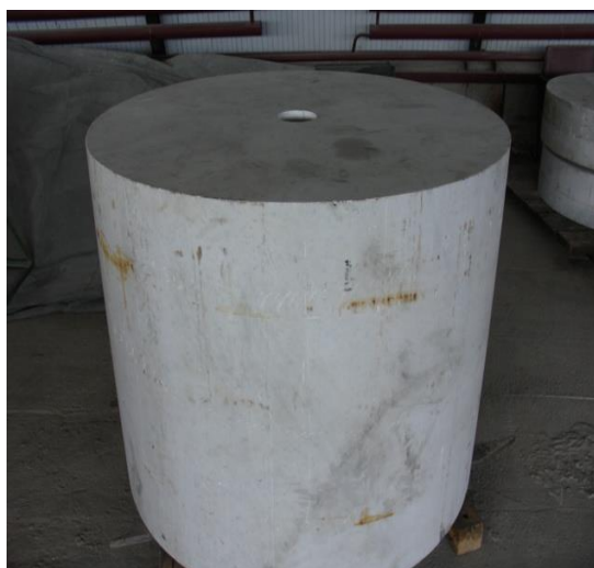
Рисунок 1.2 - Модель монолитного кальцитового пласта со скважиной
