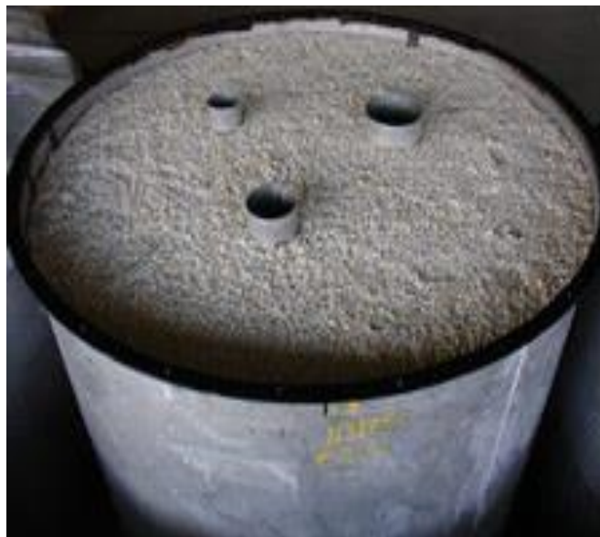
Рисунок 1.4 - Эталон пористости кальцитовых пород (однофракционный, диаметр 2 м, диаметром скважин 124, 156 и 216 мм)
