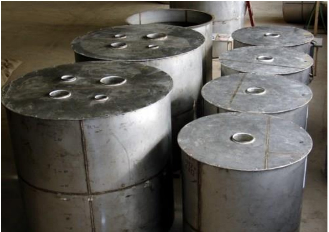
Рисунок 1.3 - Эталон пористости песчаных пород с диаметром скважин 124, 156, 216 и 295 мм (диаметр корпуса модели 2 м и высота 2 м)
