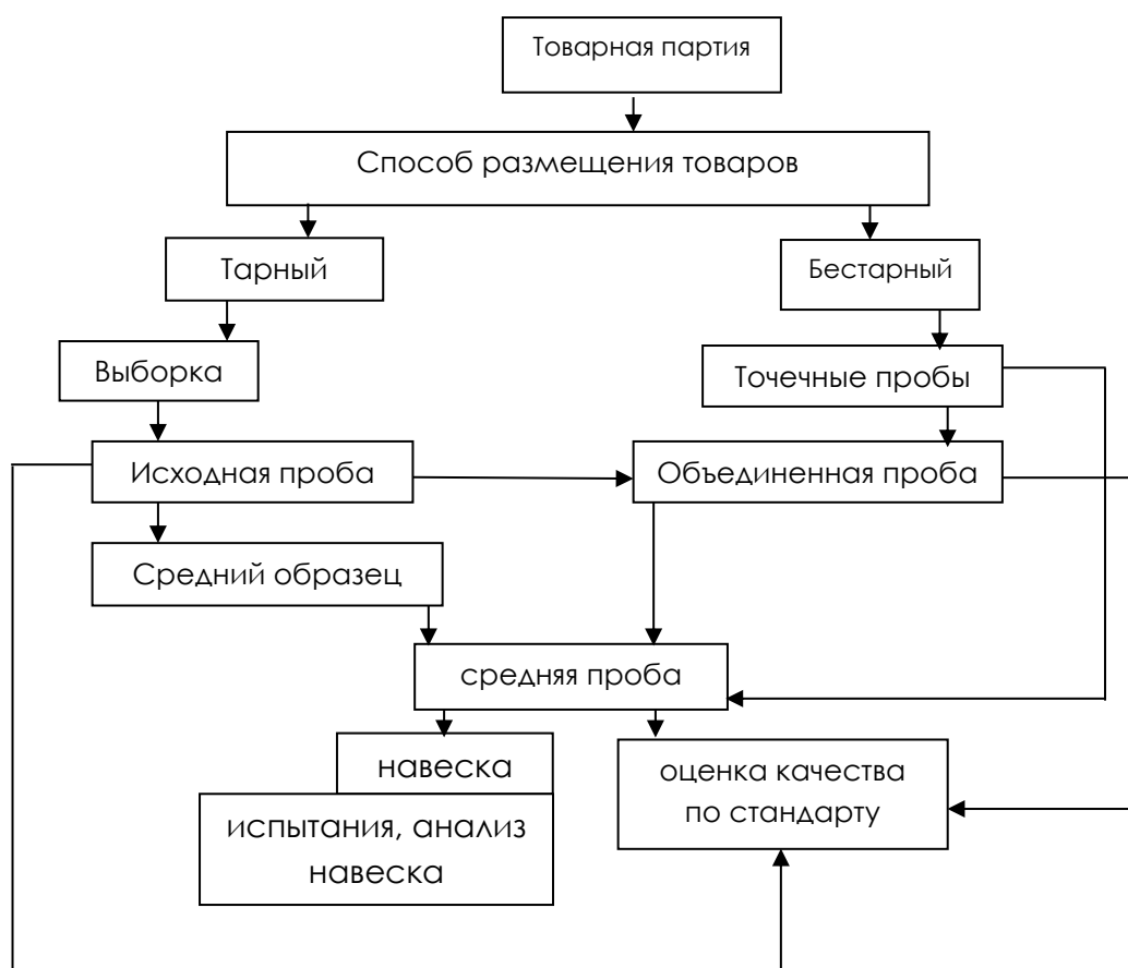
Рис. 16. Последовательность отбора проб и образцов из товарных партий разных способов размещения
