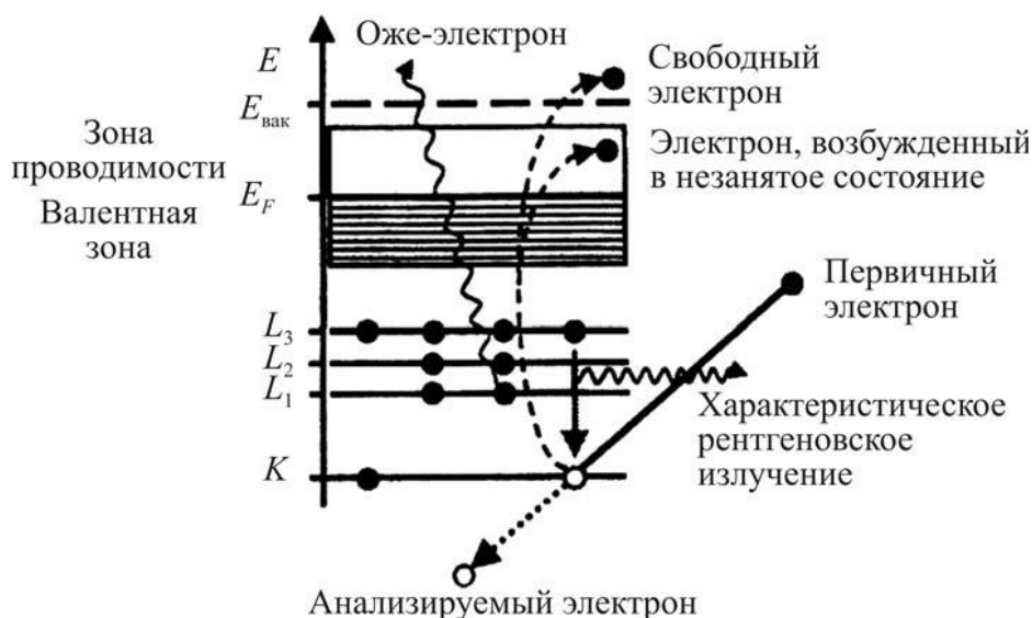
Рис. 3.23. Схема процессов, протекающих при взаимодействии падающего электрона с атомом
