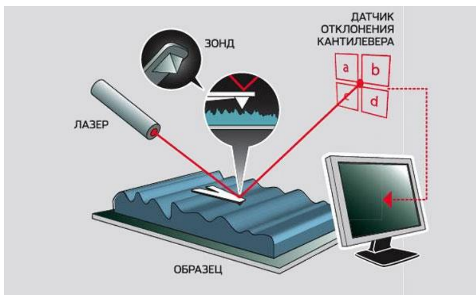
Рис. 4.20. Блок-схема получения информации о рельефе поверхности
