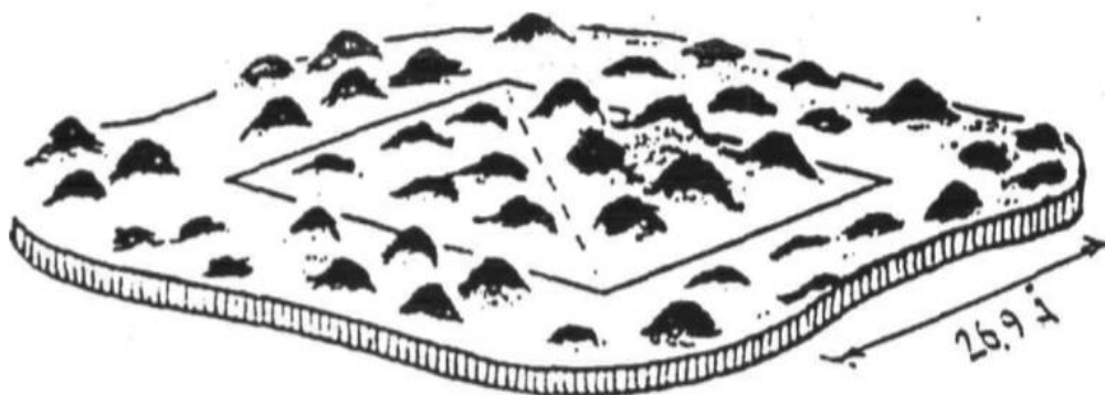
Рис. 3.34. Рельеф участка реконструированной поверхности кремния (7x7), снятый с помощью сканирующего туннельного микроскопа: каждый холмик объединяет группу атомов кремния. Ромбом выделена перестроенная (1x1 – 7x7) ячейка кремния
