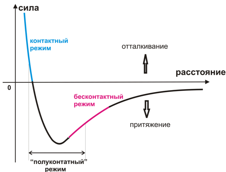
Рис. 4.21. Режимы работы атомно-силового микроскопа
