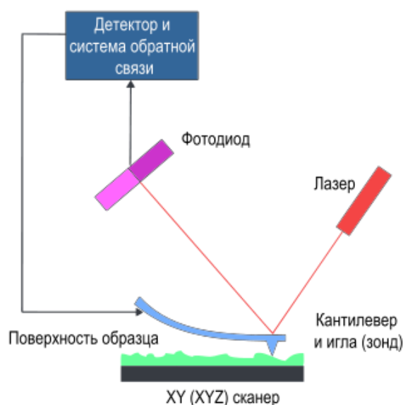
Рис. 4.19. Схема работы атомно-силового микроскопа
