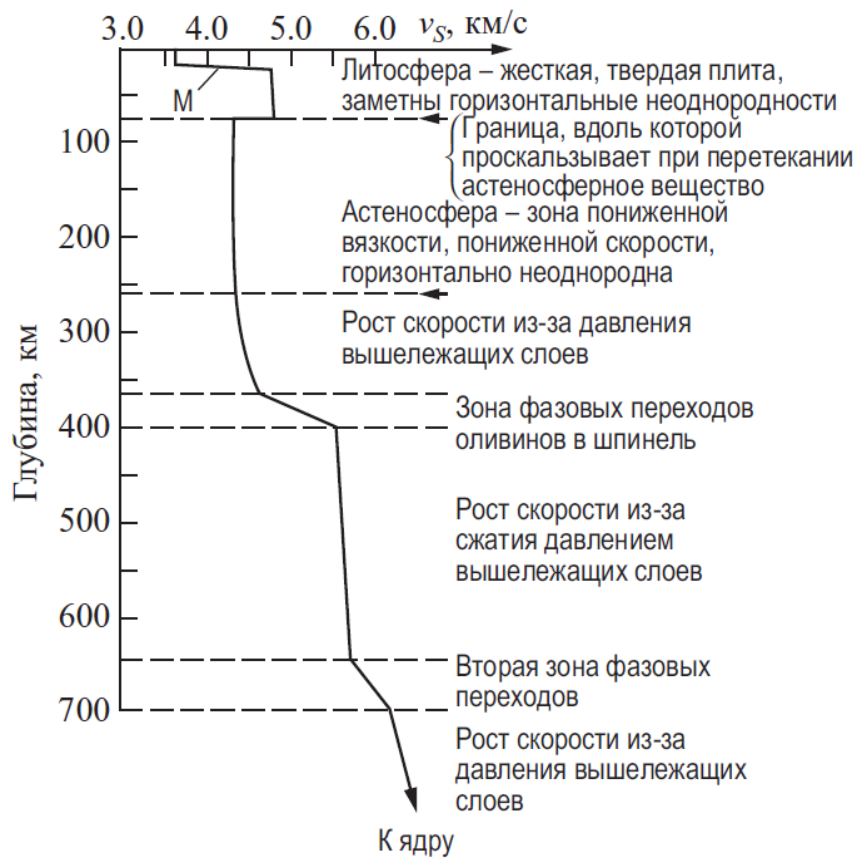
Рис. 7. Одна из первых современных реальных моделей мантии Земли (построена по данным сейсмологии и результатам лабораторных исследований при высоких давлениях)
