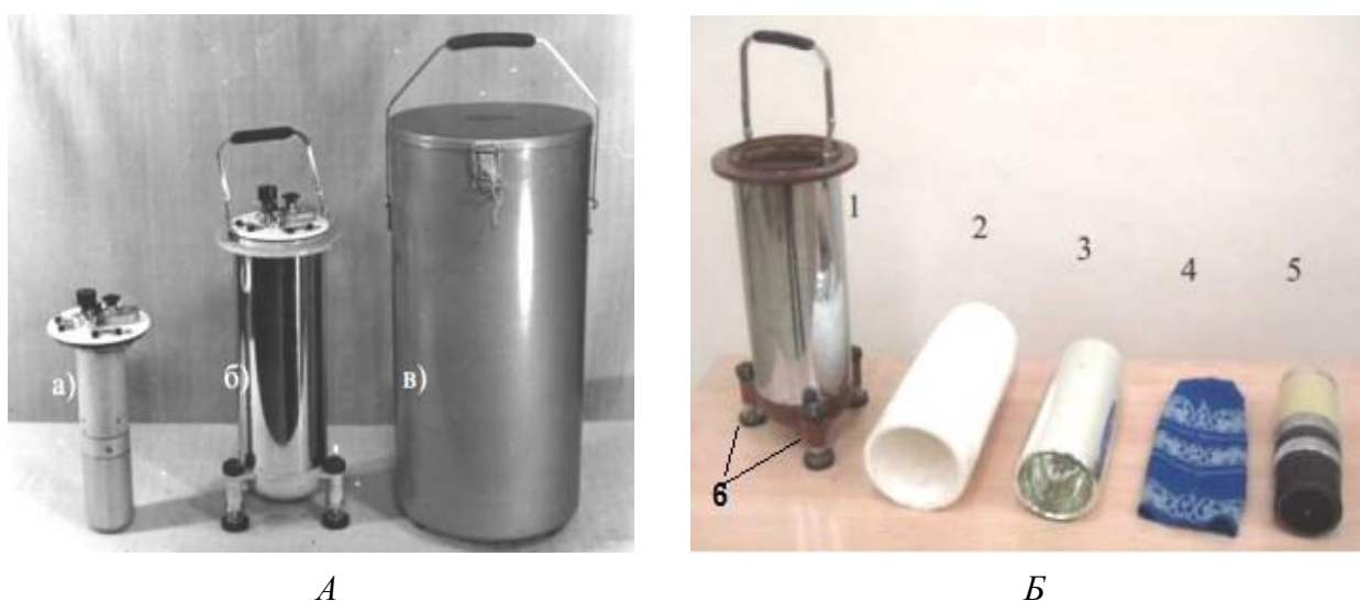
Рис. 2.1. А – внутренняя (средняя) часть гравиметра с верхней панелью (а), общий вид прибора в сборе (б), транспортировочный футляр (в); Б – составные части гравиметра: 1 – внешний кожух, 2 – цилиндр из пенопласта, 3 – сосуд Дьюара, 4 – шерстяной чехол, 5 – средняя часть прибора (без верхней панели), 6 – установочные (подъемные) винты
