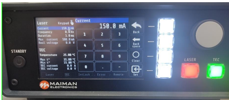
Рис. П1.4. Внешний вид меню установки тока лазерного диода контроллера лазера Maiman Electronics MBL1500
