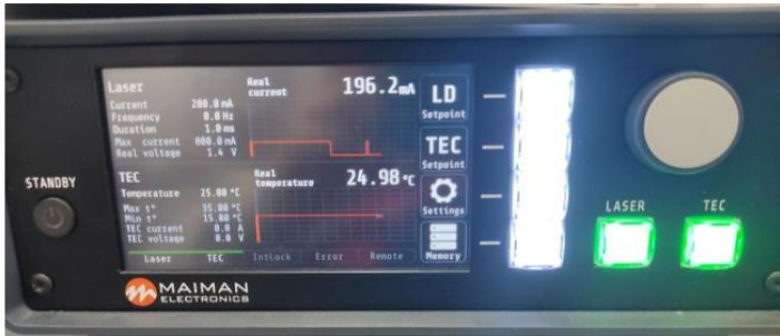
Рис. 2.8. Внешний вид передней панели контроллера лазера Maiman Electronics MBL1500 в режиме генерации оптического излучения
