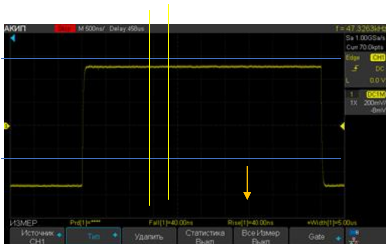
Рис. 5.15. Осциллограмма переднего фронта импульса в режиме курсорных измерений Данные занести в табл. 5.2.
