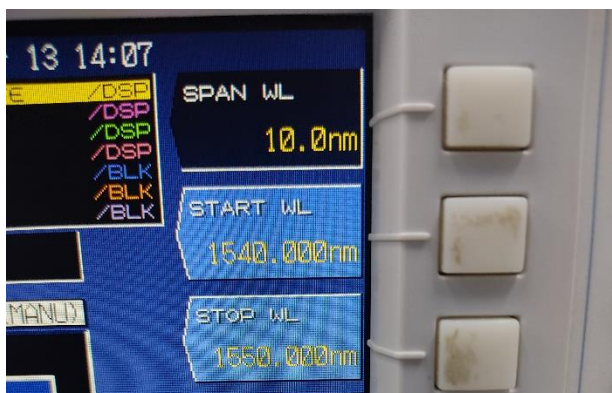
Рис. ПЗ.2. Вкладка SPAN
