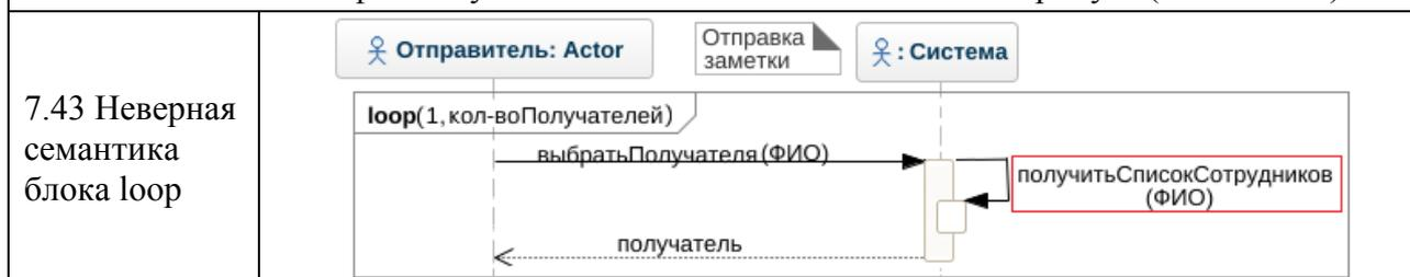
По сценарию в этом фрагменте SD при выборе получателя по его персональным данным на каждом шаге цикла из системы должен быть получен объект списокСотрудников. Это является ошибкой: последнее действие следует выполнить один раз до цикла loop
