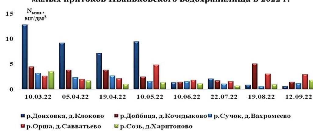
Рис. 4. Изменение концентраций минерального азота в замыкающих створах малых притоков Ивановского водохранилища в 2022 г.
