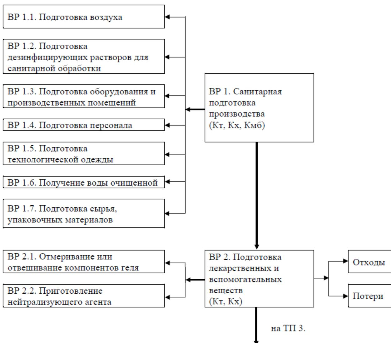
*Рис. 1. Технологическая схема производства геля с экстрактом шишек ели*
