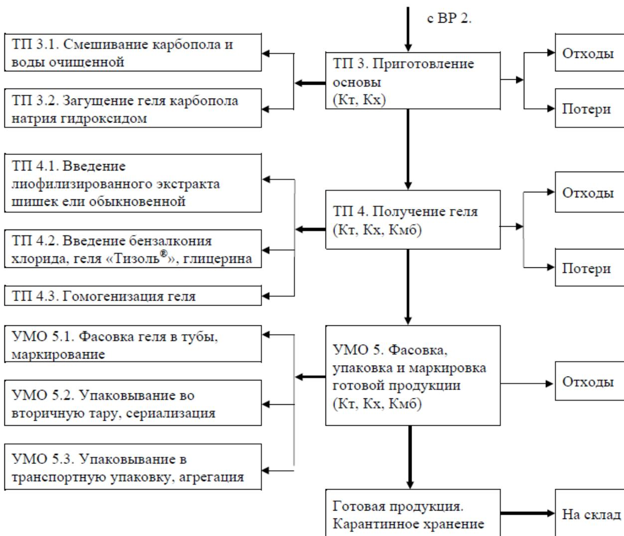
Рис. 1. Технологическая схема производства геля с экстрактом шишек ели (продолжение)
