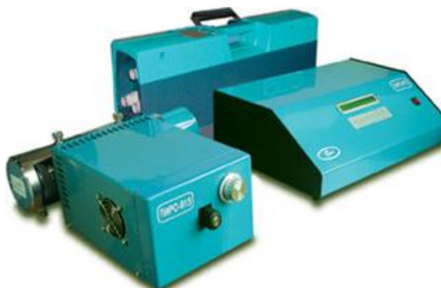
Рис. 1. Анализатор ртути «РА-915М» в комплекте с пиролитической приставкой «ПИРО-915+»
