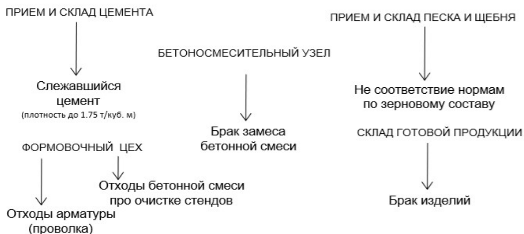
Рис.1. Этапы производства железобетонных изделий
