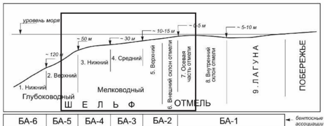
Рис. 2. Совмещенная модель. Батиметрические зоны карбонатного шельфа [3]
