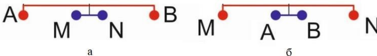
Рис. 1. Исследуемые установки, а – Шлюмберже, б – взаимная Шлюмберже
