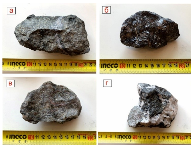
Рис. 1. Исследуемые образцы руд различных минеральных ассоциаций: а – кварц-халькопирит-пиритовая, б – кварц-полиметаллическая, в – кварц-гематит-полиметаллическая, г – карбонат-полиметаллическая
