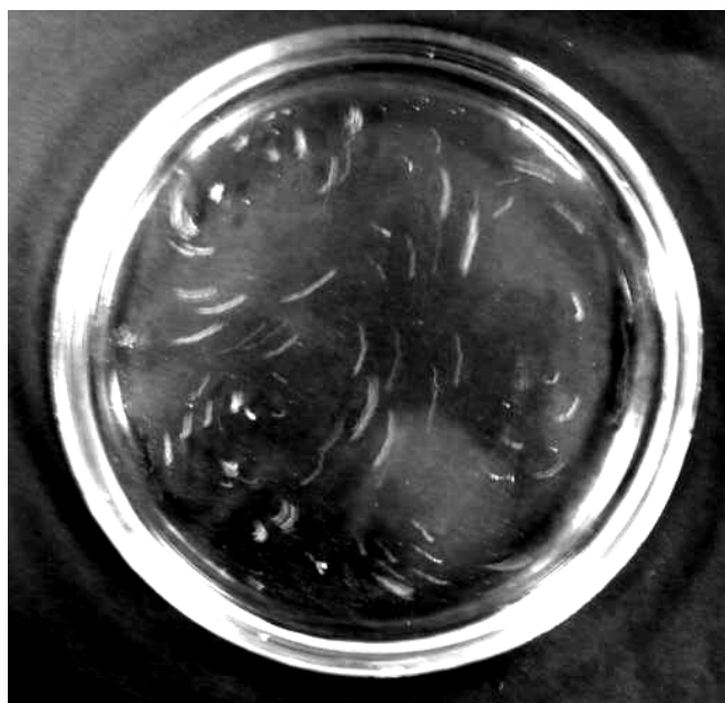
Рис. 3.18. Трековая фотография частичек камфары, визуализирующих трехвихревое течение воды в чашке Петри
