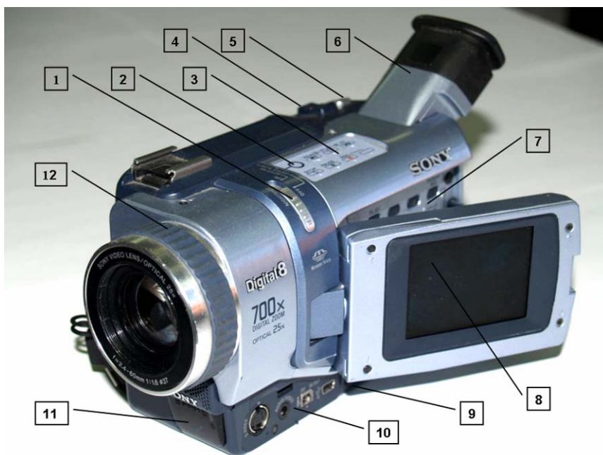
Рис. 1.1. Цифровая видеокамера: 1-кнопка включения ночного режима; 2-кнопка включения суперночного режима; 3-панель управления видеомэгнитофоном; 4-регулятор оптического увеличения; 5-кнопка фотографирования; 6-видоискатель; 7-панель управления видеокамерой; 8-ЖК монитор; 9-кнопка отключения автофокусировки; 10-панель интерфейсных разъемов; 11-инфракрасный прожектор; 12-регулятор ручной фокусировки
