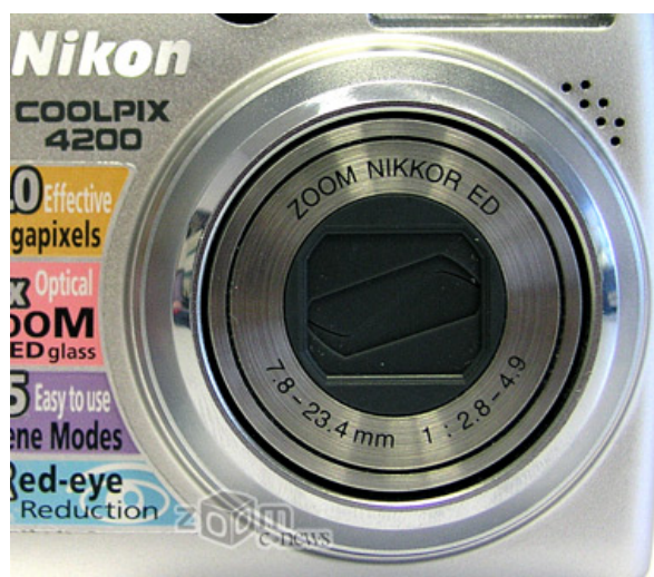
Рис. 1.14. Типичное расположение информации на объективе: левая часть нижней надписи - фокусное расстояние зума, правая часть - светосила
