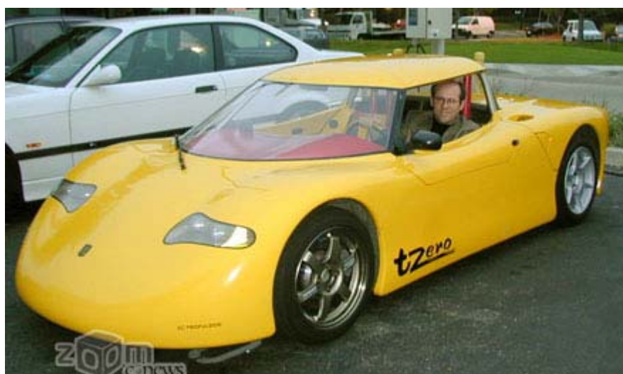
Рис. 4.28. Электромобиль спортивного класса на литиевых аккумуляторных батареях.
