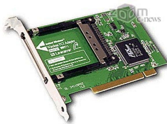
Рис. 1.35. PCMCIA интерфейс-контроллер позволяет оборудовать компьютер Wi-Fi-картой с интерфейсом PC-card
