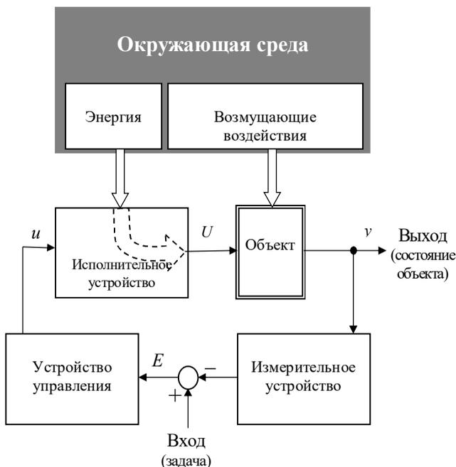
Рис. 1.2. Структура системы автоматического управления:
