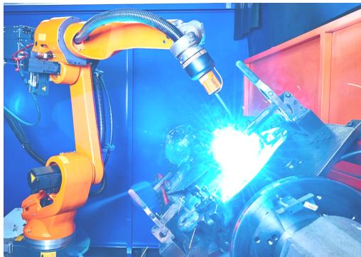
Рис. Л.23. Сварочный робот
