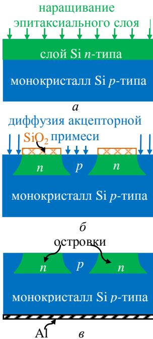
Рис.13.1. Формирование изолированных областей в эпитаксиально-планарной структуре
